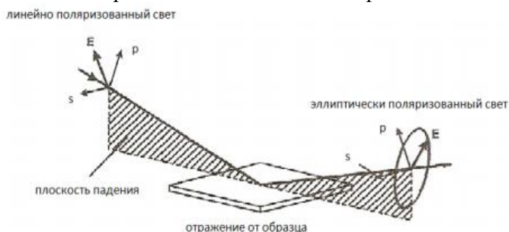
Рисунок 1 - Взаимодействие поляризованного света с образцом
