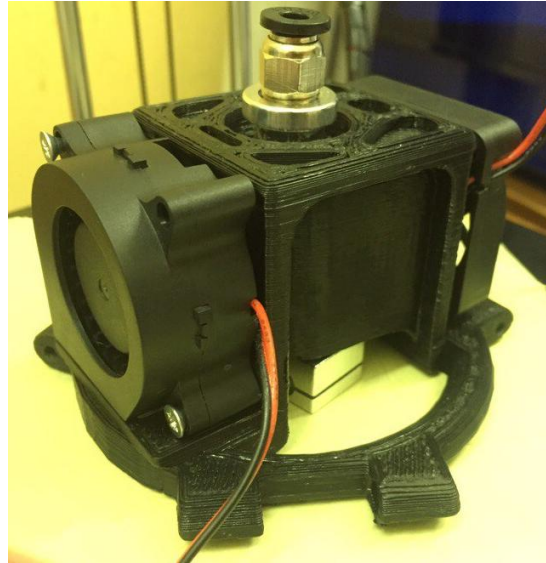
Рис.10 Узел в сборе с установленными вентиляторами охлаждения.
