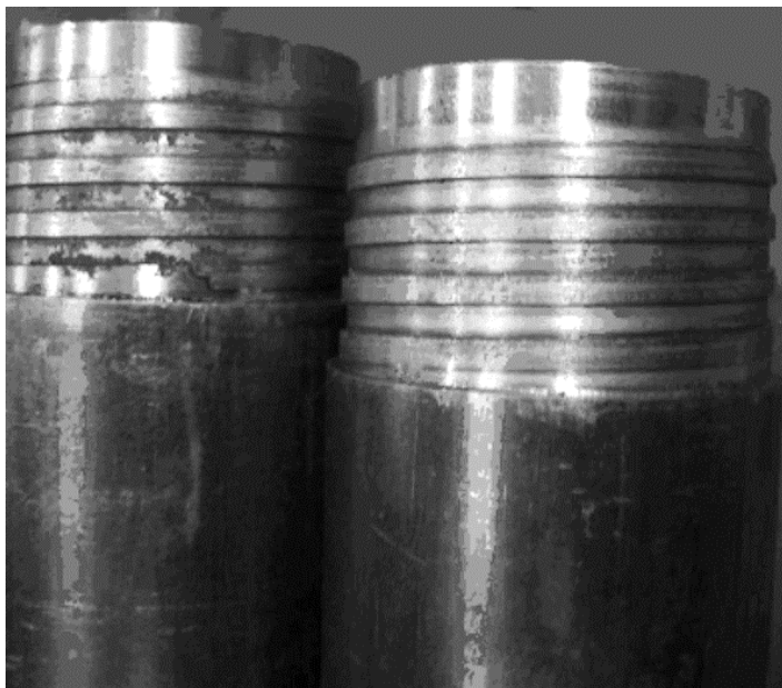
Рис. 1. Резьба бурильной трубы после лазерного упрочнения.
