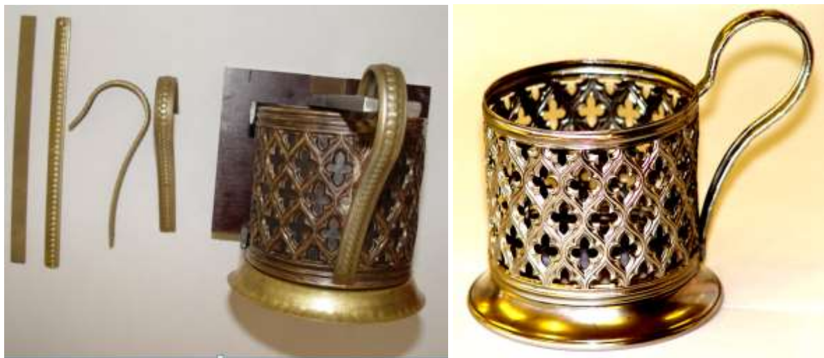
Рис.6. Специальная оснастка для пайки ручки и готовое изделие.
