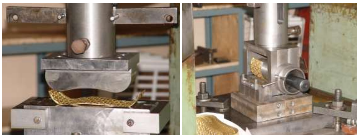
Рис.4. Штампованные образцы и штампы для производства обечайки.
