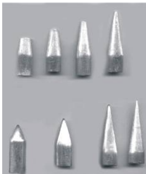
Рисунок 2. Образцы, отштампованные по двум вариантам технологического процесса
