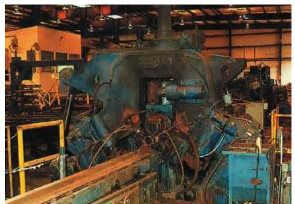
Рис. 4. Кольцепрокатный агрегат 55-112 (корпорация Timken, США): а – выходная сторона прошивного стана; б – выходная сторона формовочного стана.
