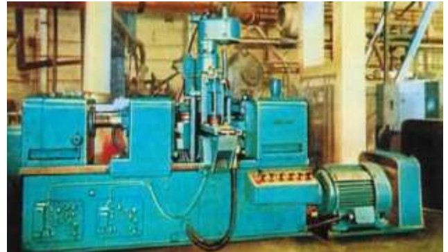
Рис. 3. Зубопрокатный стан ЗПС 120
