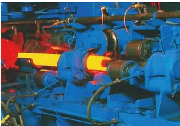
Рис. 4. Кольцепрокатный агрегат 55-112 (корпорация Timken, США): а – выходная сторона прошивного стана; б – выходная сторона формовочного стана.
