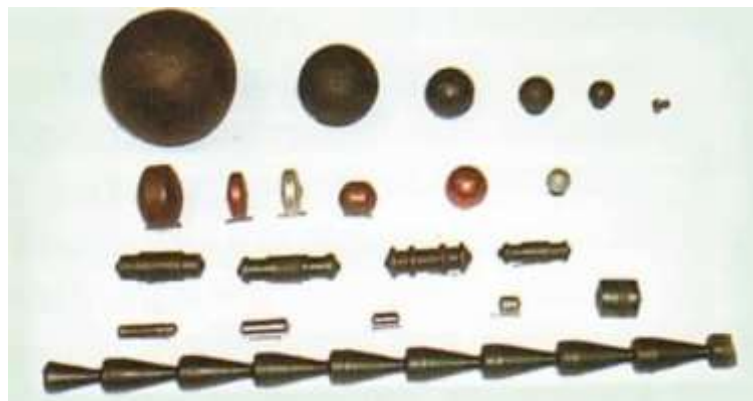
Рис. 1 Шаровые и цилиндрические изделия, прокатываемые в винтовых калибрах
