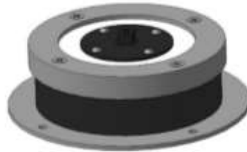
Рис. 2. Активный демпфер на основе магнитореологического эластомера
