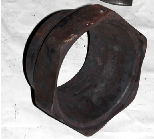
Рис. 1. Поковка детали «корпуса хвостовика ТВС-2М»: а – поковка; б – трехмерная модель (сечение)
