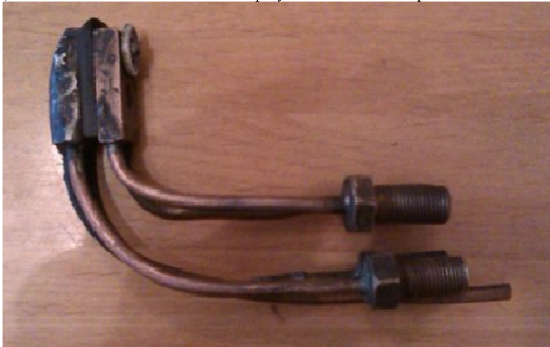
Рисунок 7. – Плазматрон для плазменно-порошковой наплавки
