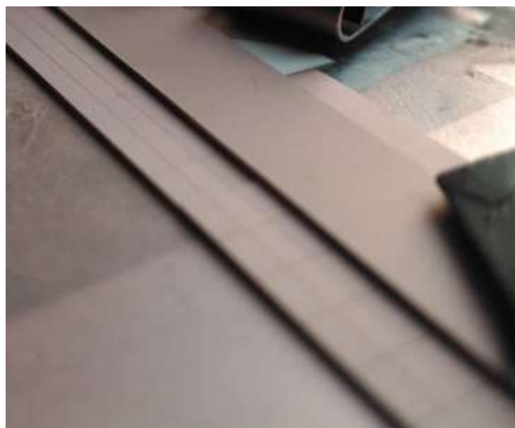
Рисунок 10. Керамическая подложка с нанесенной на нее медью
