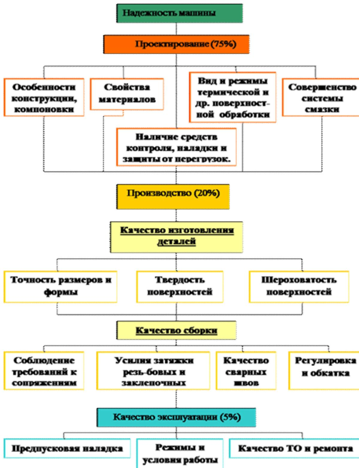
Рис. 1. Обеспечение требуемого уровня качества и надежности машины по этапам жизненного цикла.
