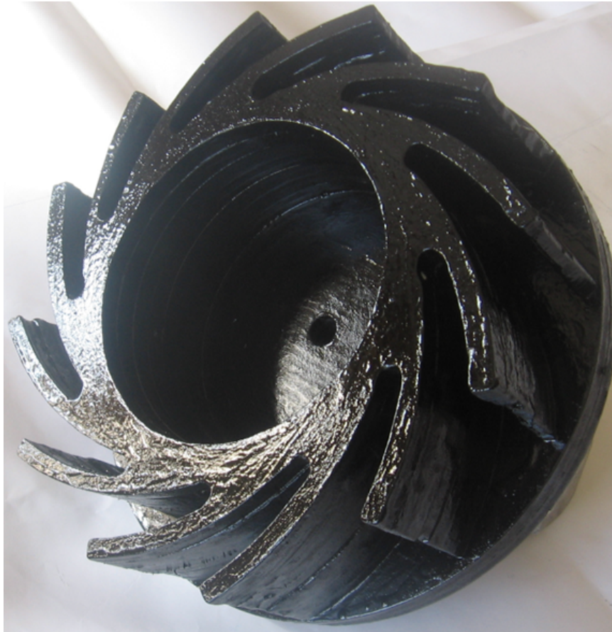
Рис. 9. Рабочее колесо вентилятора, изготовленное с применением САПР ТП «АДЕМ» на вертикально-фрезерном станке с ЧПУ мод. СС – F1210E
