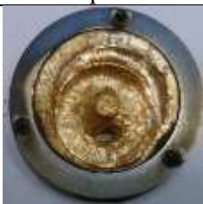
Рис. 7. Расплавленная мишень на МАК2”
