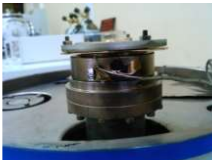
Рис. 6. Магнетрон МАК 2'' с измененной конфигурации для запуска с неохлаждаемой мишенью
