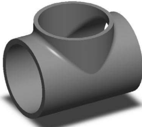
Рис. 2. 3D модель цельноштампованного толстостенного тройника
