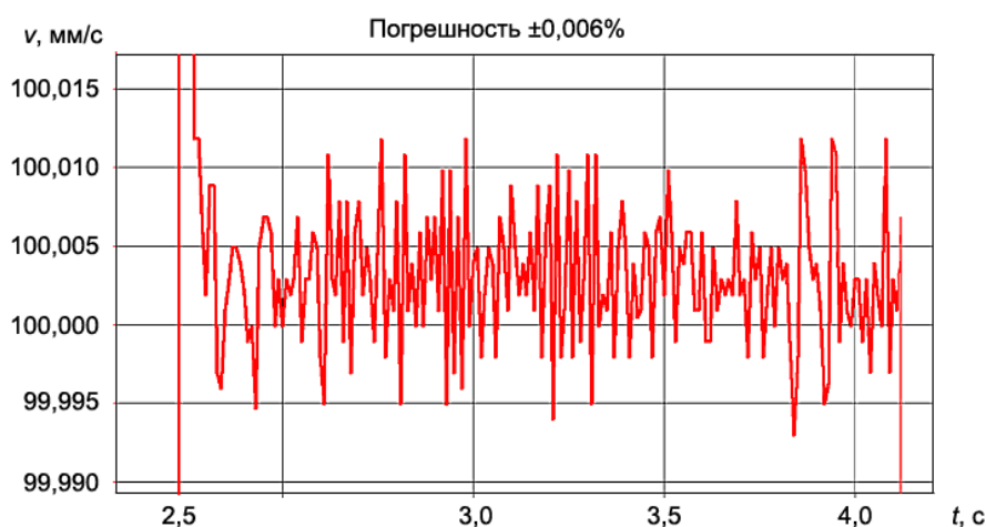
Рис. 4. График изменения скорости при движении на высоких скоростях
