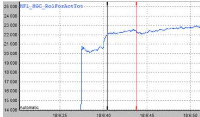
Рисунок 4. Определение усилия F1 во время прокатки полосы
