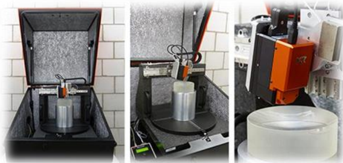
Рис. 1. Автоматизированный АСМ “NanosurfNanite” с возможностью измерений под углом
