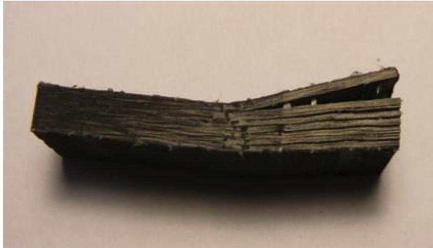
Рис. 4. Образец углепластика с прошивкой арамидом после разрушения при сдвиге
