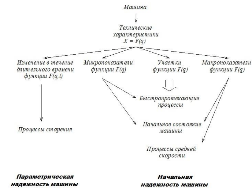
Рис. 2 Выходные параметры станка, как числовые показатели его технических характеристик
