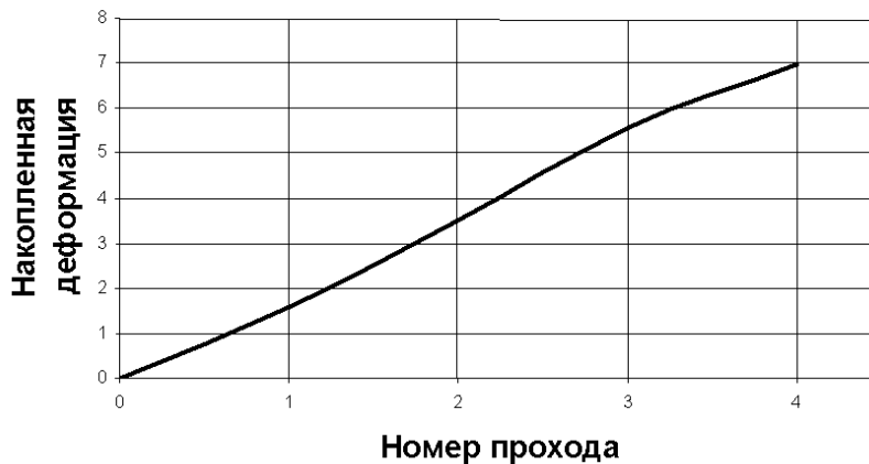
Рис. 4. Зависимость накопленной деформации \varepsilon_n от номера прохода n
