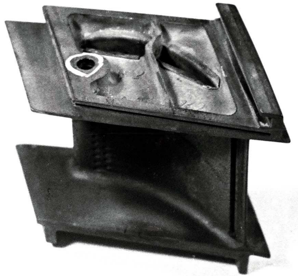
Рис. 1. Внешний вид сопловой лопатки с изношенным отверстием под штифт
