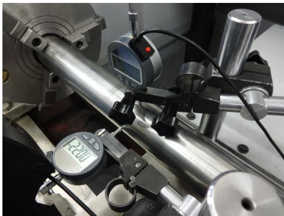
Рис.1. – Фото установки для проверки токарного станка 16К20Ф3 на точность.
