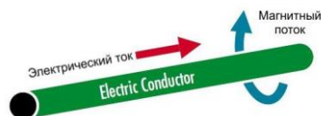
Рис. 12. Принцип действия электромагнитного привода [2]
