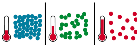
Рис. 1. Принцип действия привода с фазовыми превращениями [2]
