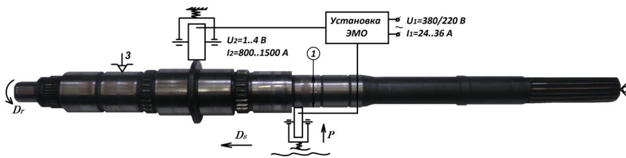
Рис. 3. Принципиальная схема упрочняющего электромеханического восстановления вторичного вала КПП автомобиля семейства «Газель»: 1 – посадочное место под подшипник качения
