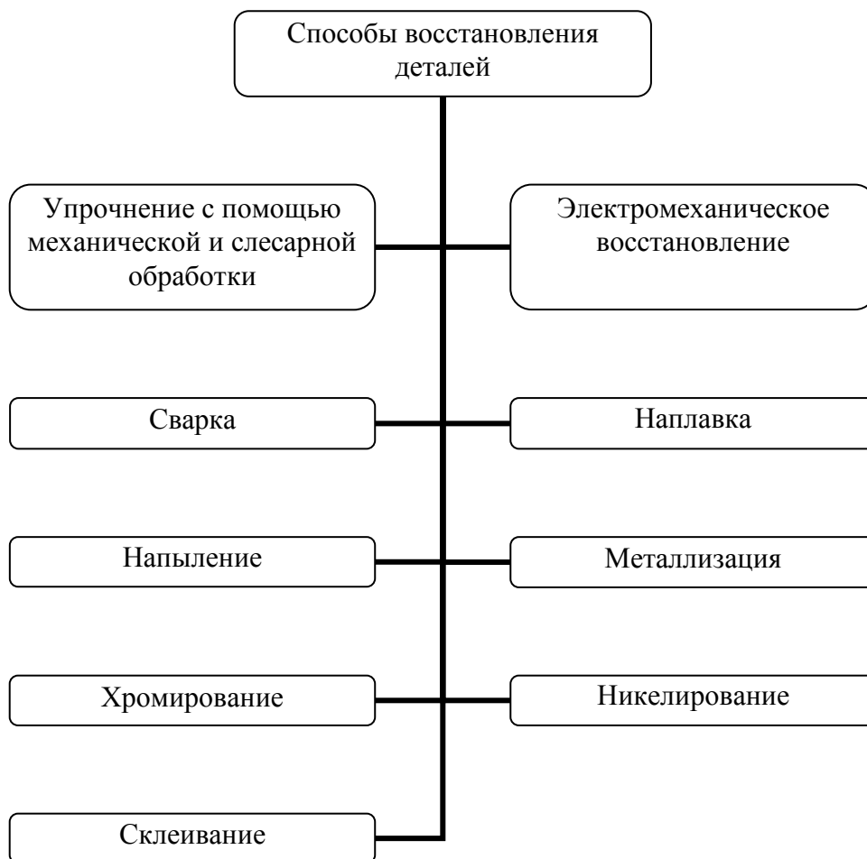
Рис. 2. Существующие технологии восстановления деталей
