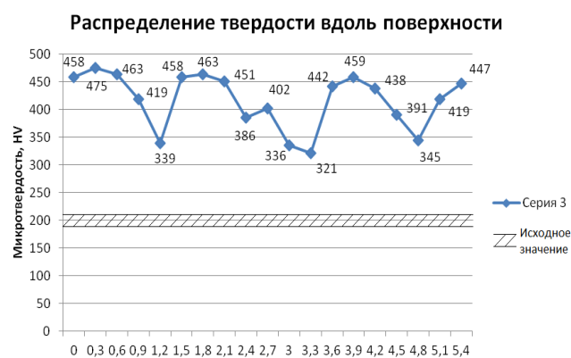
Рис. 4. Распределение твердости вдоль поверхности детали
