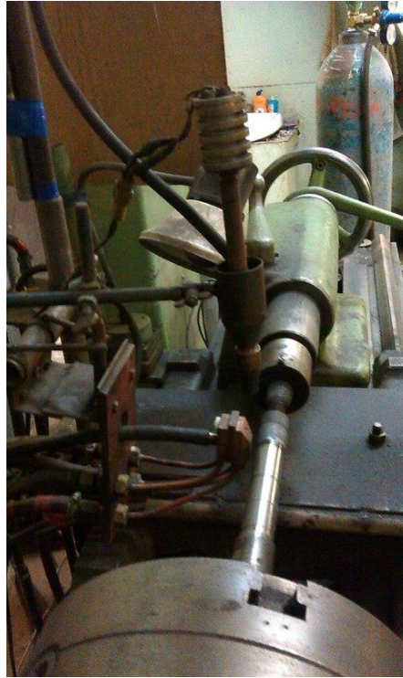
Рис. 4. Узел плазменно-порошковой наплавки.
