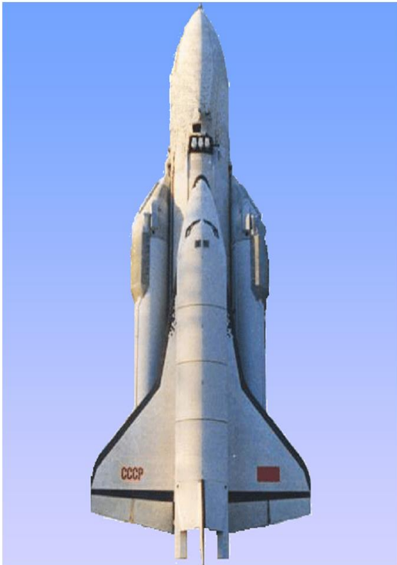
Ракетно-космический комплекс “Энергия-Буран”. Общая масса деталей, изготовленных из сплава ВТ23 после ВТМО, 6т (в “Буране”) и 14т (в “Энергии”): шпангоуты, балки, лонжероны и стыковочные узлы
