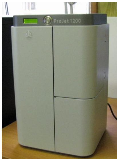
Рис. 1. Общий вид 3D-принтера ProJet 1200
