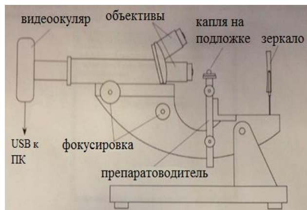
Рис. 5. Гониометр ЛК-1: а) общий вид; б) схема прибора
