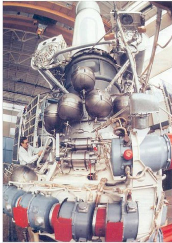
Космический корабль “Астрон”. Шаровые баллоны, изготовленные из сплава ВТ23 путем сверхпластической деформации (СПД), сварки и термоупрочнения ( \sigma_B \geq 1250 МПа)
