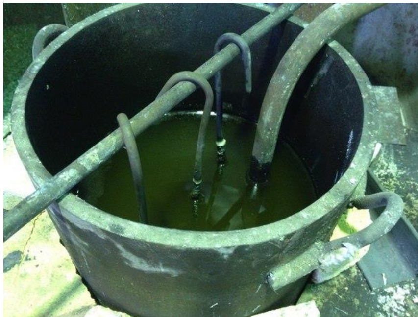
Рис.2. Печь-ванна для изотермической выдержки в расплаве селитры
