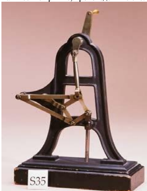
Рис. 6. Модель S35- Прямолинейный механизм
