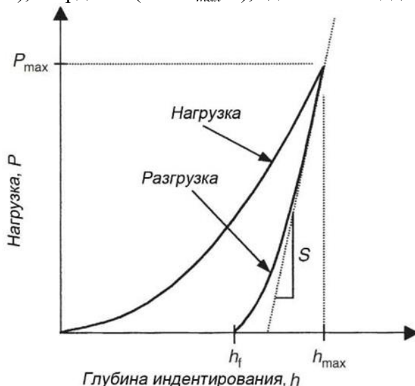
Рис. 2. Схема нагружения и разгрузки образца
