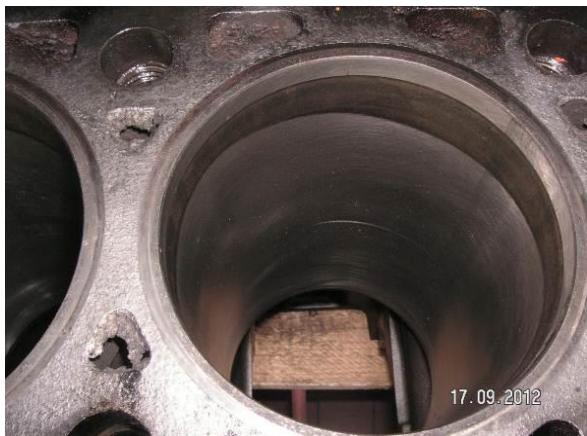
Рис. 1. Кольцевой износ гильзы цилиндров MAN в зоне верхнего компрессионного кольца
