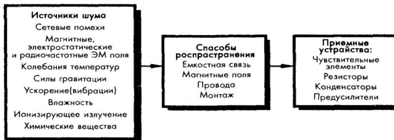
Рис. 6. Источники вносимых шумов и способы их распространения
