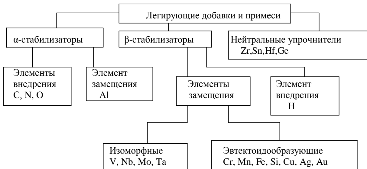
Рис. 1. Схема деления легирующих элементов и примесей на группы
