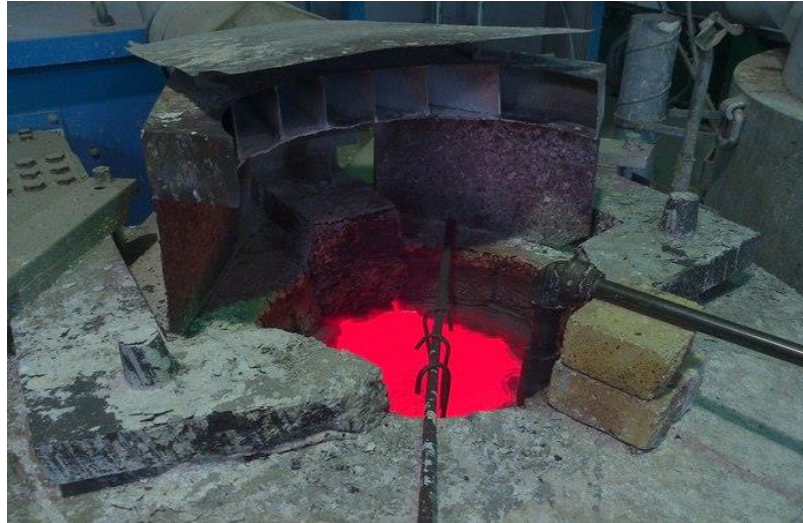
Рис.1. Печь-ванна для нагрева под закалку образцов из стали 30ХГСА
