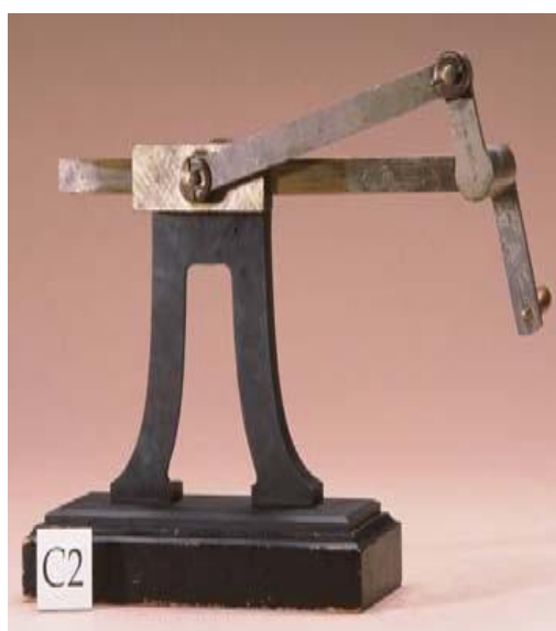
Рис. 8. Модель C2- Кривошипно-ползунный механизм
