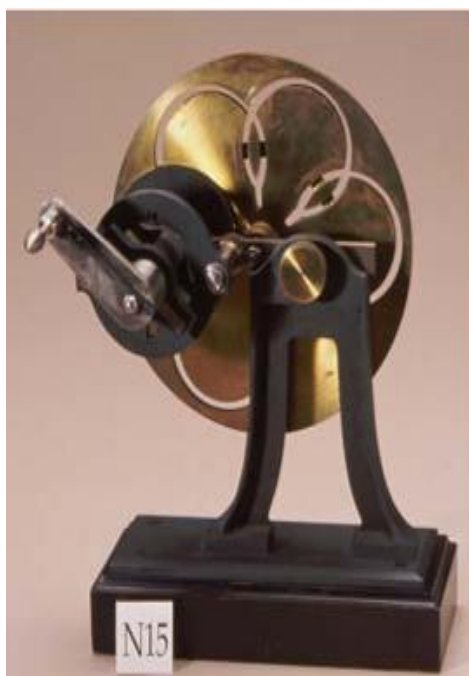
Рис. 7. Модель N15- Скачковой механизм
