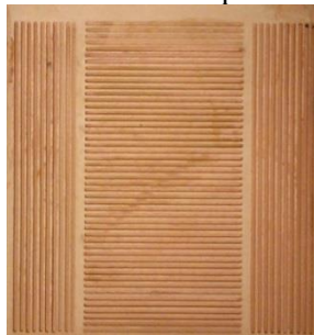
Рис. 5. Заготовка с гальванически металлизированными «траншеями» в стеклотекстолите
