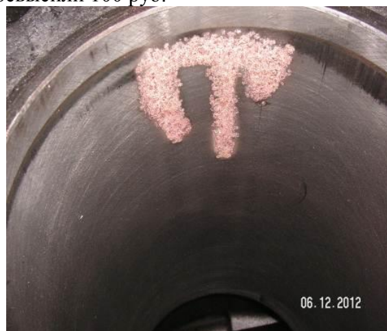
Рис. 4. Гильза цилиндров CAT-3116 с композиционным покрытием в зоне задира от сломанного кольца
