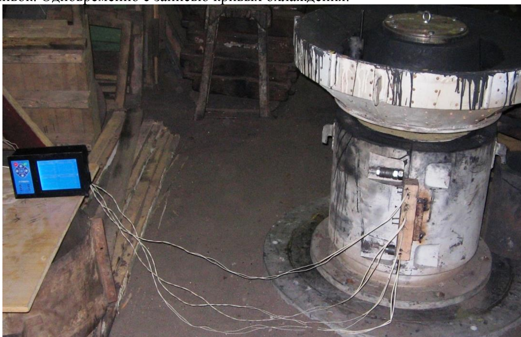
Рис. 3. Схема установки термопар на заданную глубину в стенку отливки и запись температур
