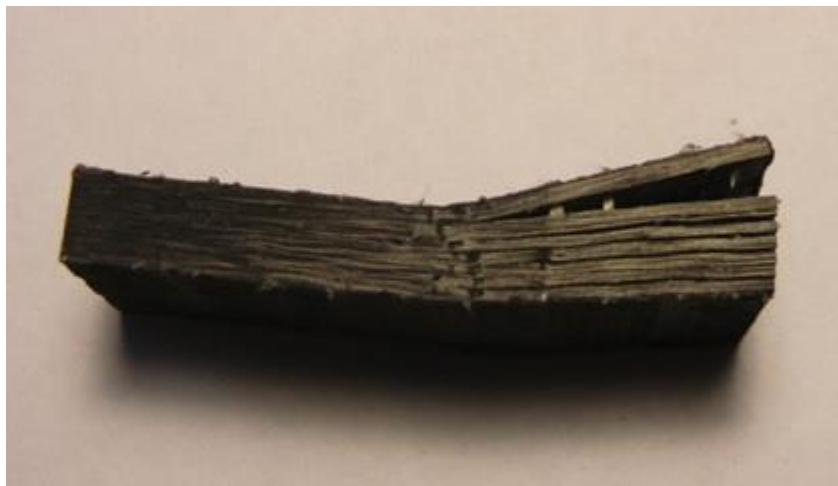
Рис. 23. Образец углепластика с прошивкой арамидом после разрушения при сдвиге На рисунке 5 приведены значение прочности непрошитых и прошитых образцов, значения приведены с доверительной вероятностью 64 %.
