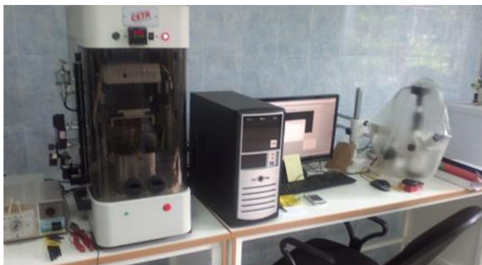
Рис. 3. Трибометр UMT-3 фирмы CETR
