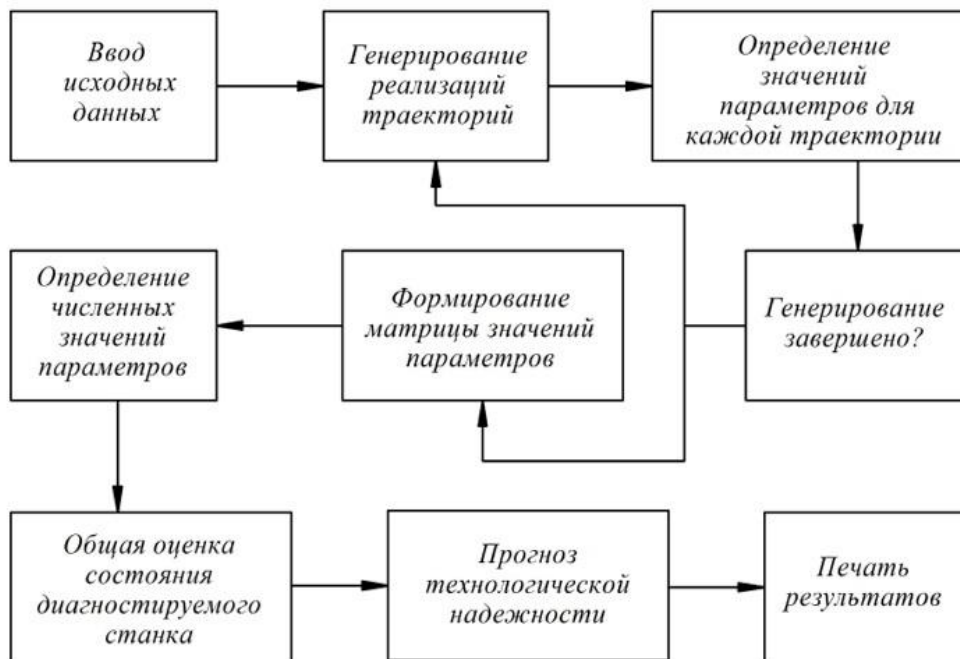
Рис 1. Алгоритм анализа траекторий формообразующей точки инструмента, закрепленного в суппорте, по управляющим параметрам.
