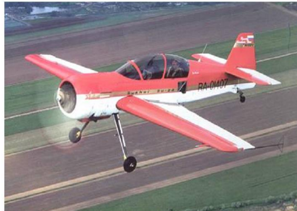
Спортивный самолет Су-29 (Су-26, Су-31, Су-31М, Су-31СК, Як-55). Из сплава ВТ23, с применением высокоскоростной закалки и старения, изготовлены детали шасси с \sigma_B \geq 1250 МПа
