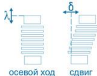
Рис. 9. Деформации сифонного узла
