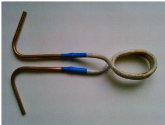
Рис.8. Индуктор для закалки после нанесения покрытия
