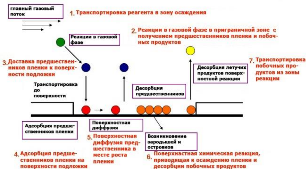
Рис. 1. Схема процесса химического осаждения из газовой фазы
