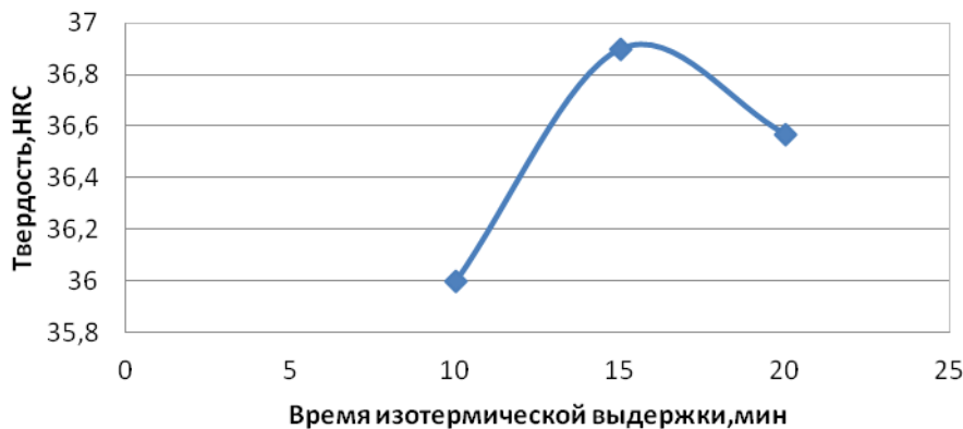
Рис.11. Твердость стали 30ХГСА с температурой изотермической выдержки 400 °С
