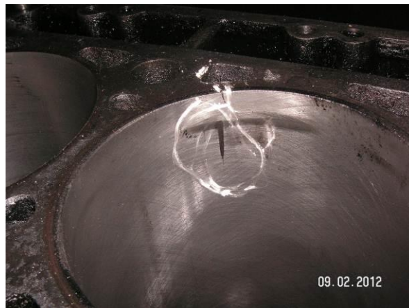
Рис. 2. Задиры гильзы цилиндра CAT-3116 после поломки поршневого кольца
