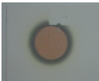
Рис. 5. Внешний вид полученного покрытия меди на подложке оксида алюминия
