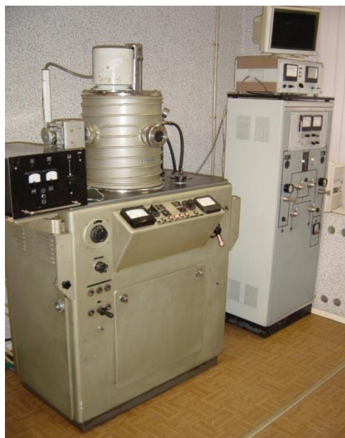
Рис. 1. Внешний вид прессованной мишени и вакуумной установки, используемой для нанесения покрытий методом магнетронного распыления
