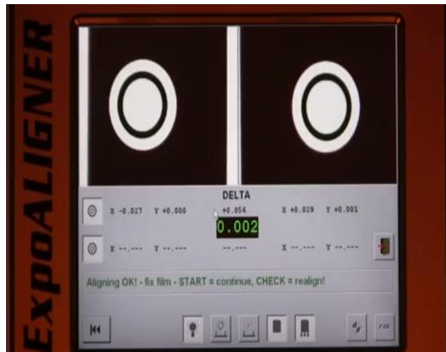
Рис. 9. Совмещение меток на установке ExproAligner
