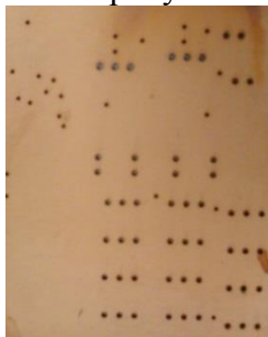
Рис. 4. Заготовка с гальванически металлизированными сквозными отверстиями
