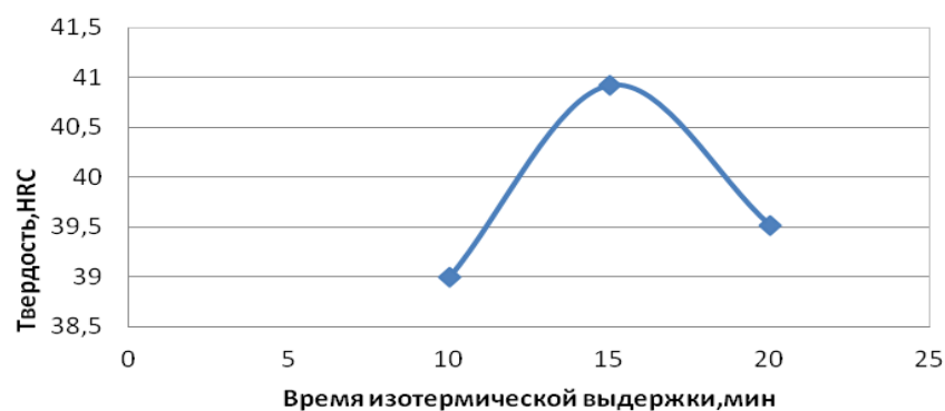
Рис.10. Твердость стали 30ХГСА с температурой изотермической выдержки 375 °С
