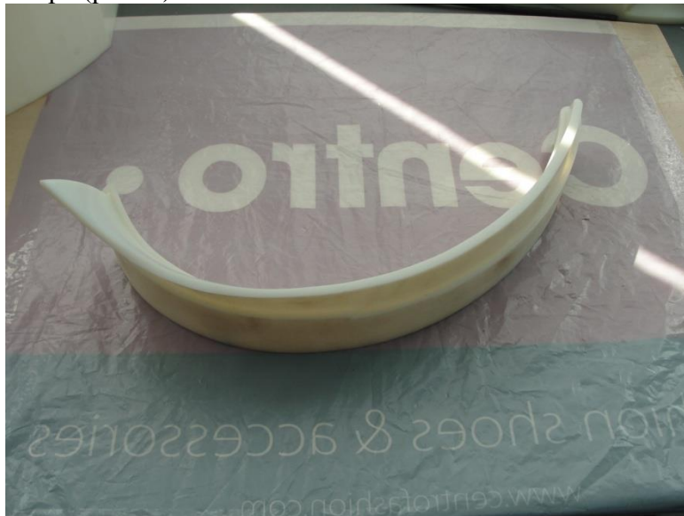
Рис. 8. Элемент модельной оснастки, изготовленный на 3D принтере.
