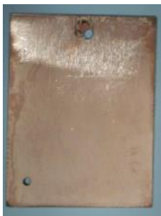
Рис. 2. Заготовка после гальванического осаждения. Состав электролита: \text{CuSO}_4 \cdot 5\text{H}_2\text{O} – 200 г/л, \text{H}_2\text{SO}_4 – 50 г/л
