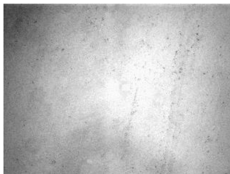
Рис. 6. Поверхность стеклянной пластины после травления в течение 30 мин:
