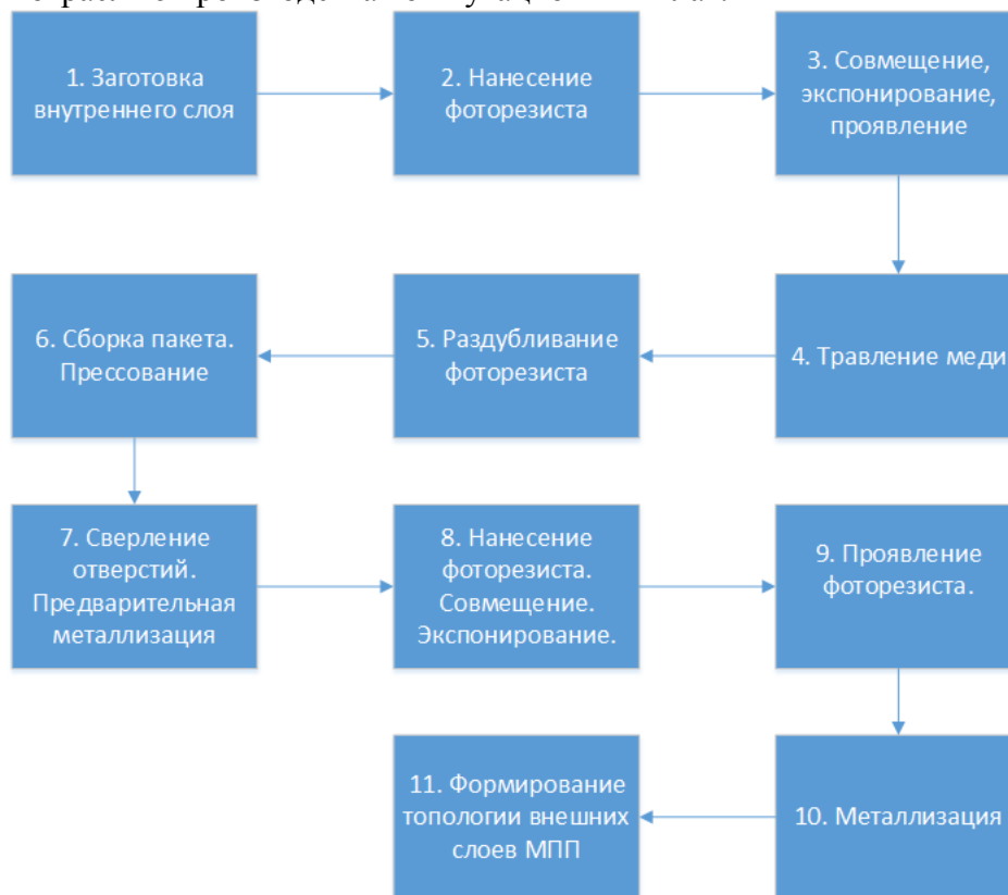
Рис. 1. Классическая технология производства МПП
