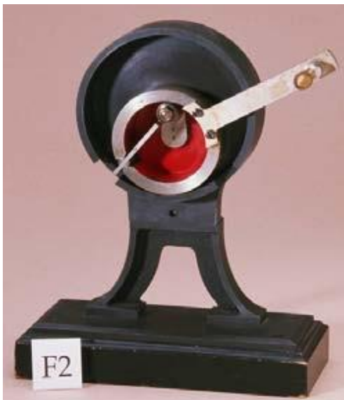
Рис. 9. Модель F2- Кривошипный насос
