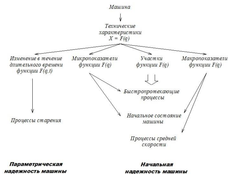
Рис. 2. Выходные параметры станка, как числовые показатели его технических характеристик. Функциями, выражающими данные зависимости, могут быть:
