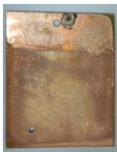
Рис. 1. Заготовка после гальванического осаждения. Состав электролита: \text{CuSO}_4 \cdot 5\text{H}_2\text{O} – 200 г/л
