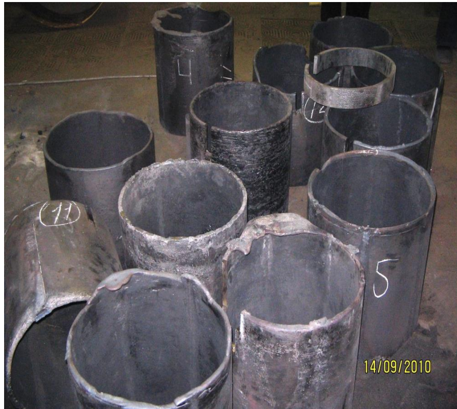
Рис. 2. Опытные заготовки трубы, отлитые для исследования параметров заливки
