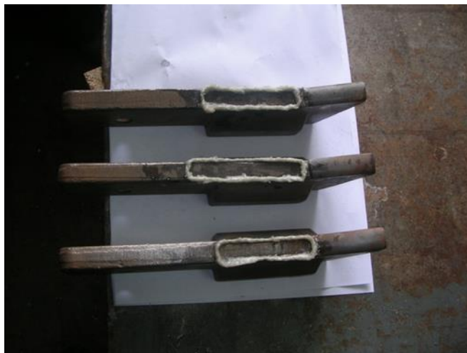
Рис. 4. Расходуемая технологическая оснастка для удержания порошковых материалов на передней части долота
