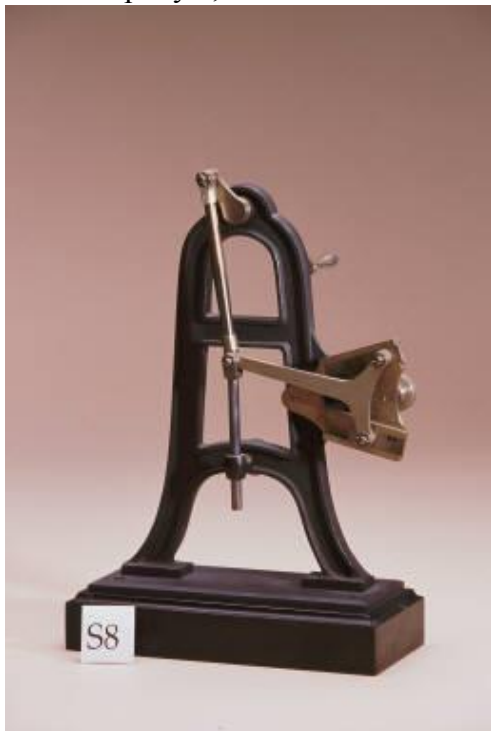
Рис. 4. Прямолинейный механизм. Модель S8
