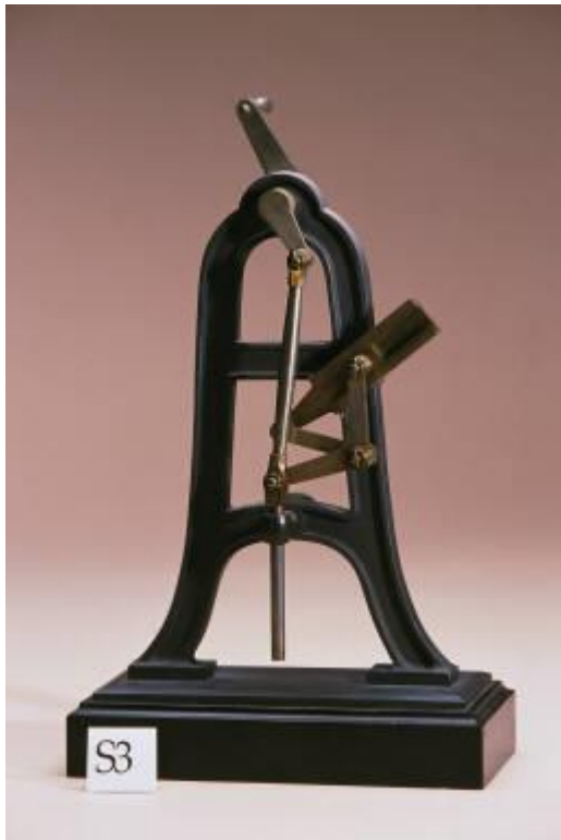
Рис. 3. Прямолинейный механизм. Модель S3
