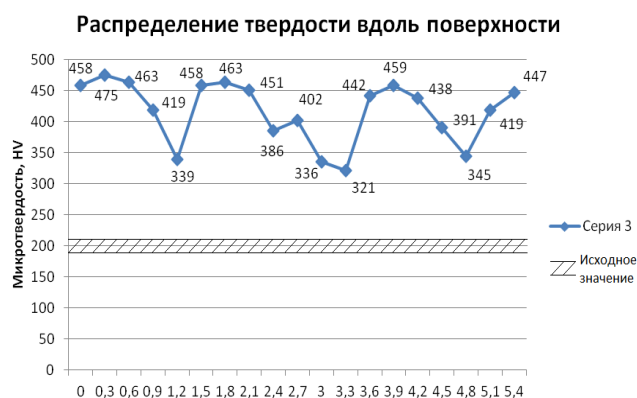
Рис. 4. Распределение твердости вдоль поверхности детали
