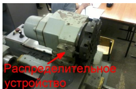
Рис. 1. Схема пневматической системы охлаждения станка 16К20Ф3.
