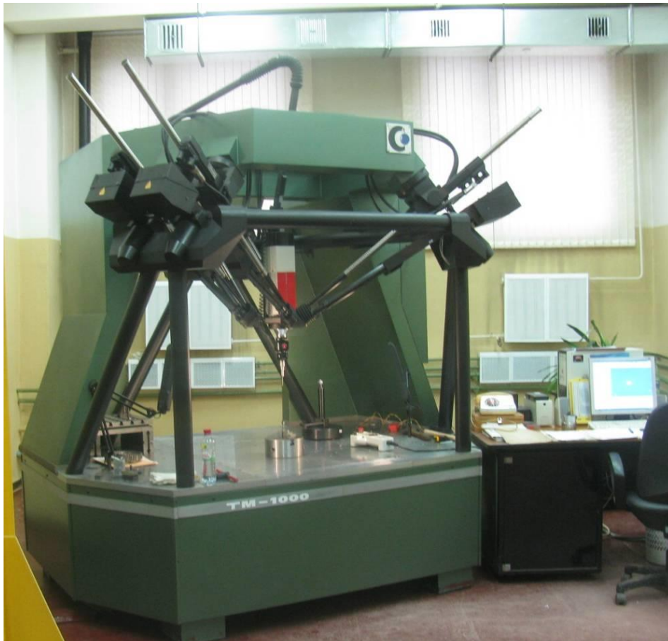
Рис.1. Шестиосевая координатно-измерительная машина
