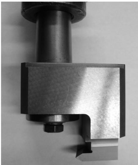
Рис.1. Фреза резьбовая охватывающая
