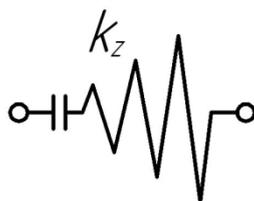
Рис. 18. Обозначение элемента с нелинейными смещениями и остаточными смещениями после разгрузки
