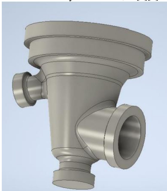
Рис. 1. Отливка типа «Корпус».
