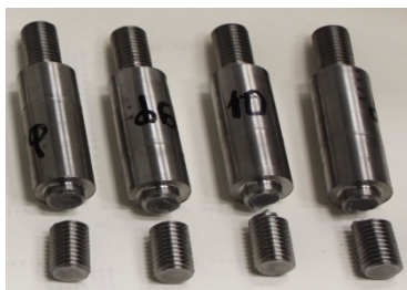
Рис. 2. Образцы после испытаний
