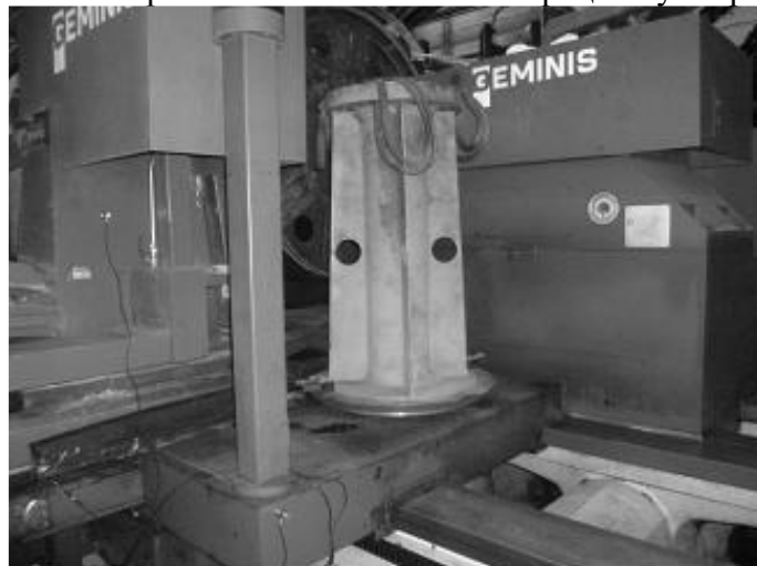
Рис.2. Дополнительная масса, установленная на суппорт
