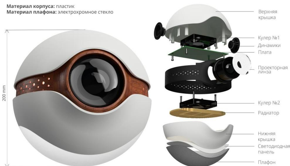
Рис. 2. Социальный робот Еуега и взрыв-схема робота.
