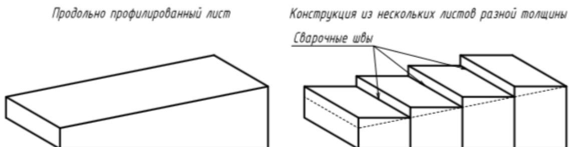
Рис. 1. Сокращение длины сварных швов и уменьшения веса конструкции благодаря использованию разнотолщинных листов.
