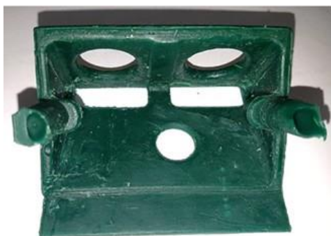
Рис. 1. Восковая модель детали «Кронштейн»
