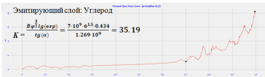
Рис. 3. Вольтамперная характеристика промежутка зонд-образец для структуры золото-опал-золото-УНС.
