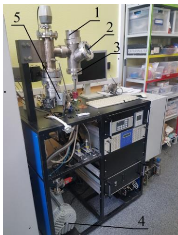
Рис.1 Вакуумная установка УВН-1М
