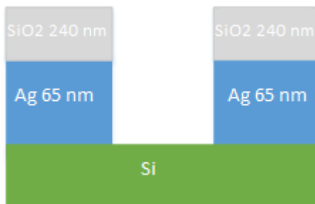
Рис 1. Боковой срез структуры для отработки процесса травления оксида кремния
