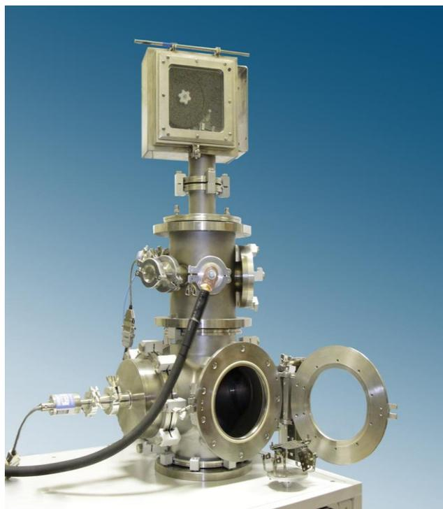
Рис. 4 - Внешний вид стенда для проведения испытаний опытного образца источника пароструйного осаждения
