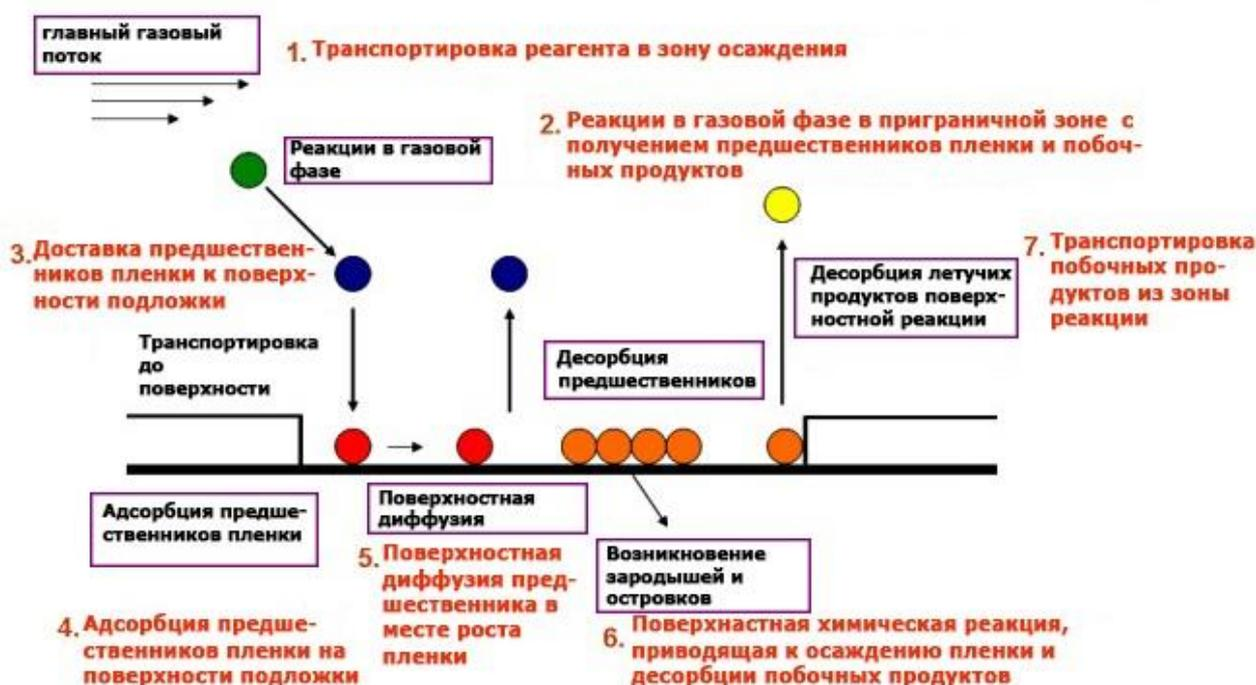
Рис. 1 – Схема процесса химического осаждения из газовой фазы
