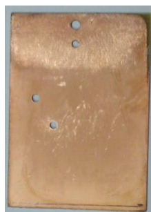
Рис. 3. Заготовка после гальванического осаждения. Состав электролита: \text{CuSO}_4 \cdot 5\text{H}_2\text{O} – 200 г/л, \text{H}_2\text{SO}_4 – 50 г/л, \text{NaCl} – 50 мг/л
