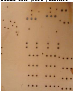
Рис. 4. Заготовка с гальванически металлизированными сквозными отверстиями
